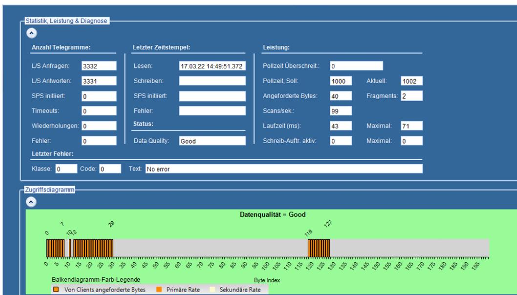
Das S7A Power Tool bietet nun für physikalische Datenblöcke erweiterte Diagnosemöglichkeiten, speziell mit dem neuen Zugriffsmonitor dargestellt über ein Balkendiagramm.
