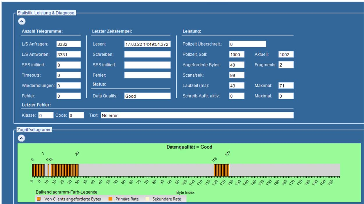
Das S7A Power Tool bietet nun für physikalische Datenblöcke erweiterte Diagnosemöglichkeiten, speziell mit dem neuen Zugriffsmonitor dargestellt über ein Balkendiagramm.
