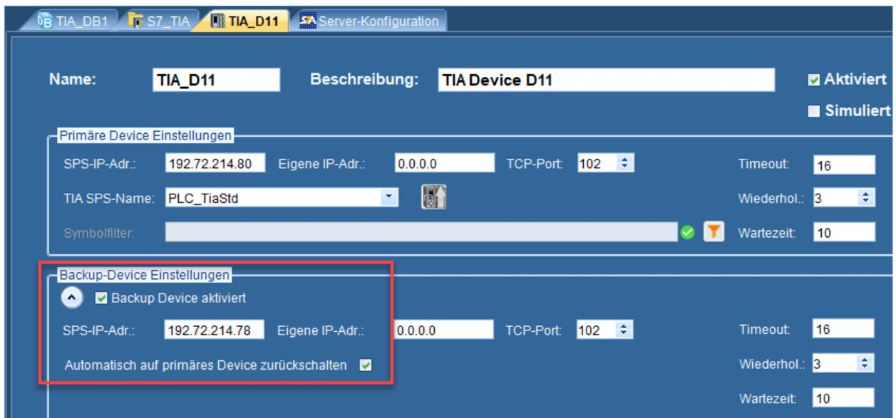
Wenn ein Backup-Device konfiguriert ist und die Checkbox **'Backup Device aktiviert'** markiert ist, schaltet der Treiber bei einer Kommunikationsunterbrechung auf der primären Verbindung automatisch auf die Backup-Verbindung um.
