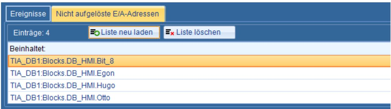
In diesem neuen Fenster werden alle iFIX E/A-Adressen und OPC Item Ids angezeigt, die von der aktuellen S7A Konfiguration nicht abgedeckt sind. In dieser ersten Version ist die Liste jedoch nicht dynamisch, wird also nicht automatisch aktualisiert. Zum Löschen und Aktualisieren stehen die beiden Buttons 'Liste löschen' und 'Liste neu laden' zur Verfügung.
